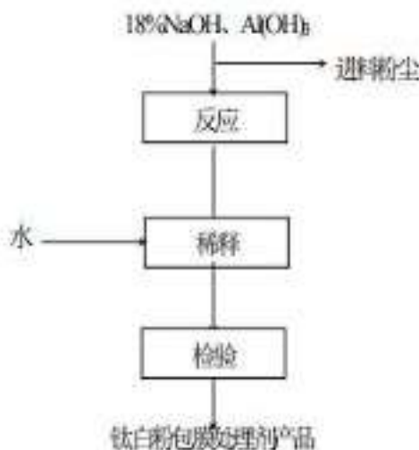
图 4-2 钛白粉包膜处理剂生产工艺流程图
