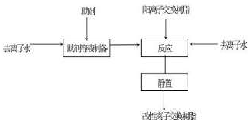
图 4-1 离子交换树脂催化剂生产工艺流程图
